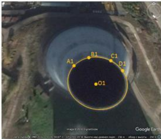
Построение верхнего эллипса по 4 точкам и определение центра
