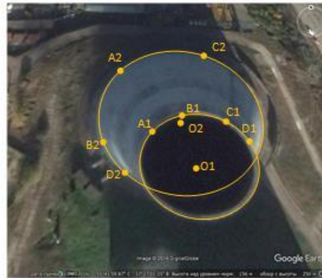
Построение нижнего эллипса по 4 точкам и определение центра
